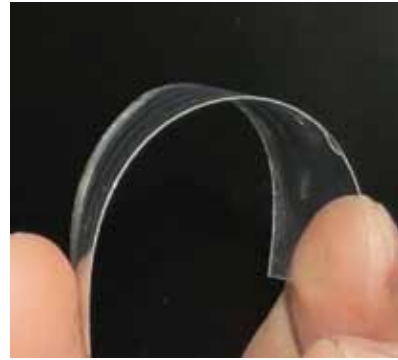
Рис. 6. Фотография шлейфа из 12 полимерных волноводов на гибкой пластиковой подложке, изготовленного в Институте проблем лазерных и информационных технологий РАН.
