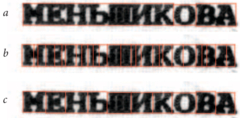
Рис. 10. Пример результатов работы второго прохода: а – исходные разрезы, б – результат объединения двух групп разрезов, с – итоговый результат сегментации.
