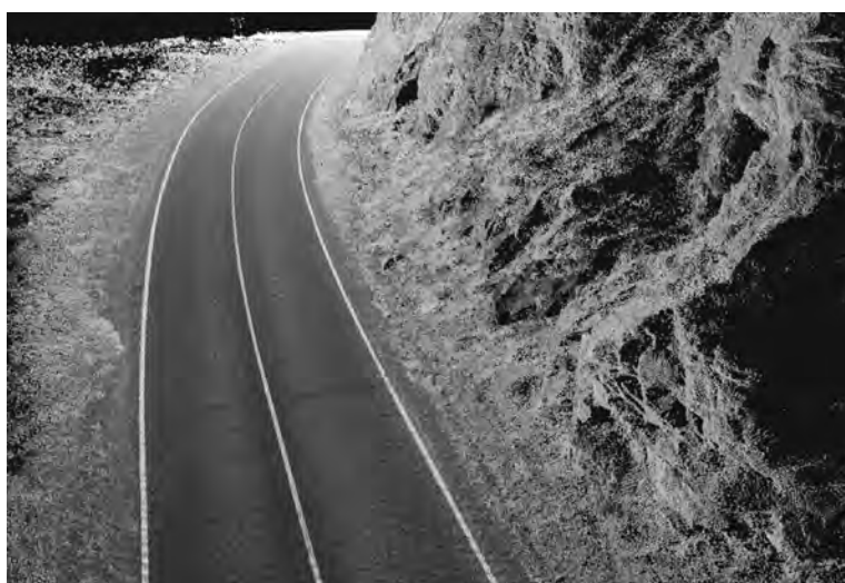
Рис. 1. Полученное облако точек лазерного сканирования включает отражения от находящихся на объекте людей, техники, растительности и т.д.
