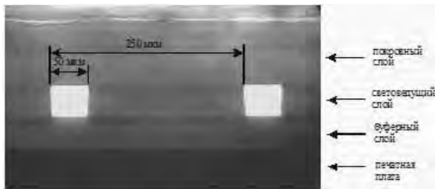
Рис. 7. Фотография многомодовых полимерных волноводов, изготовленных на печатной плате методом контактной фотолитографии под действием актинического излучения с длиной волны 365 нм. Вид с торца
