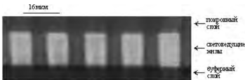
Рис. 9. Фотография массива полимерных волноводов, сформированных на печатной плате методом УФ фотолитографии. Вид с торца. Ширина и высота волноводов составляют 10 и 15 мкм соответственно, расстояние между световедущими жилами равно 6 мкм
