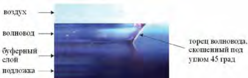
Рис. 12. Фотография полимерного волновода со скошенным под углом 45 град торцом
