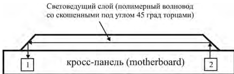
Рис. 11. Схема волновода со скошенными под углом 45 град торцами для стыковки его с фотоприемниками (1) и излучателями (2)
