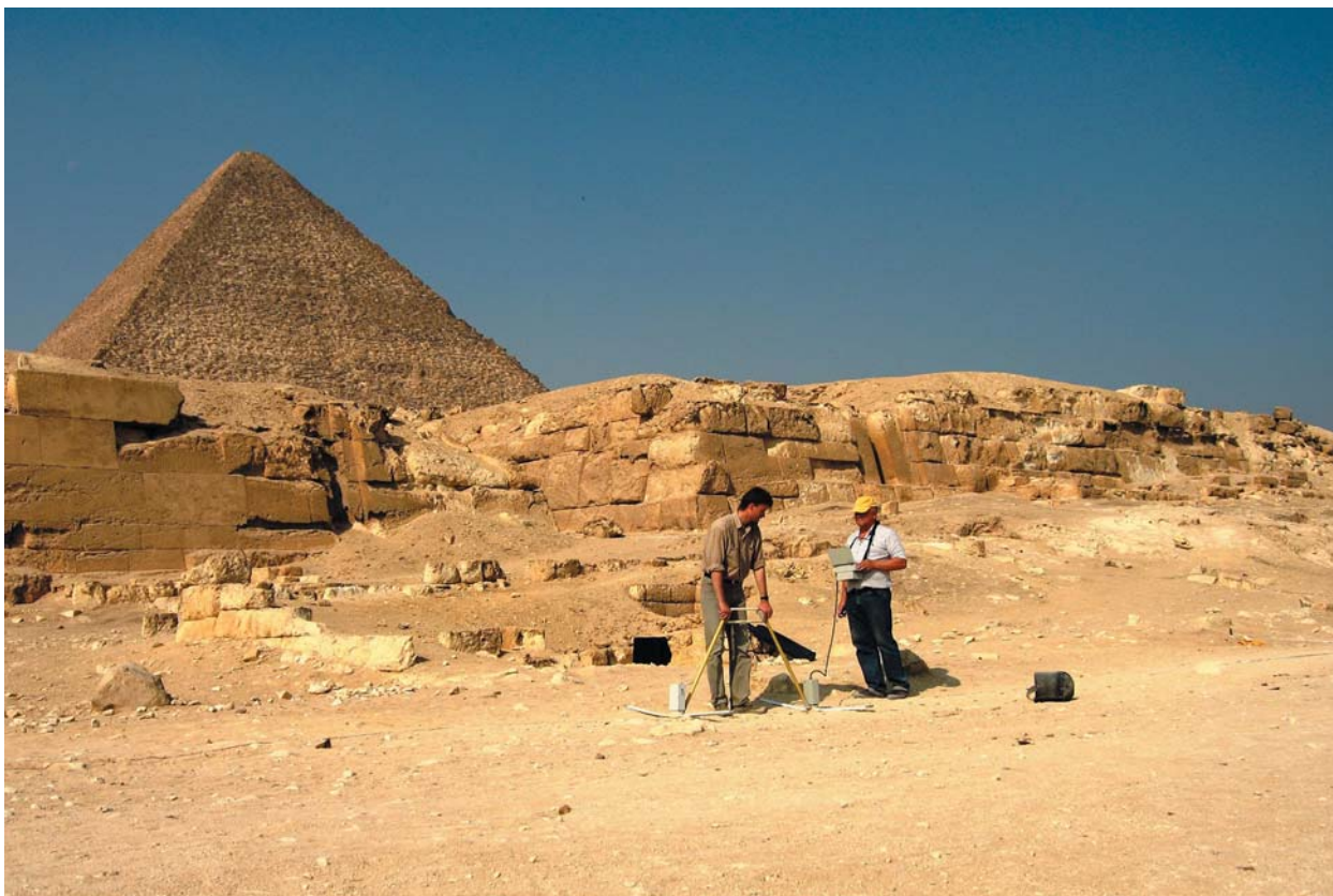
Ил. 1. Археологическая разведка участка Российской концессии в Гизе с помощью георадарного устройства
