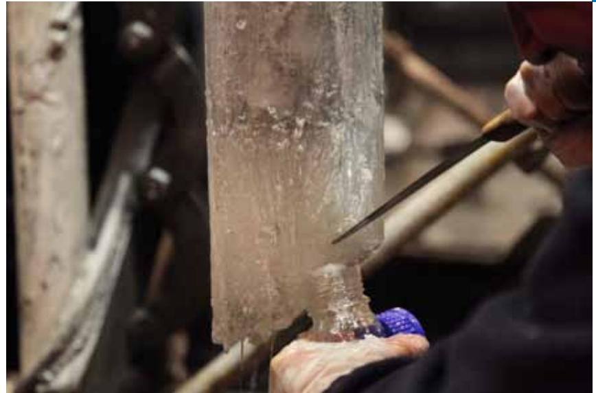
Рис. 5. Нарост из замерзшей озерной воды, образовавшийся на нижнем торце бурового прибора после проникновения в подледниковое озеро Восток
