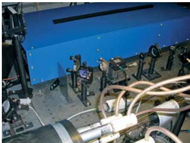
Рис. 2. Экспериментальная линия задержки на субпетаваттной установке ИПФ РАН.
