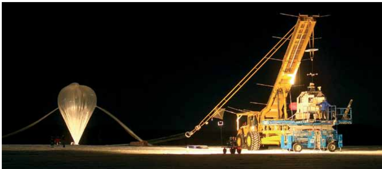
Рис. 4. Запуск Фурье-спектрометра MIPAS-B и инструмента TELIS на полигоне космического центра Esrange, Швеция. Объем аэростата: 400 000 м 3 ; вес полезной нагрузки около 1 000 кг.
