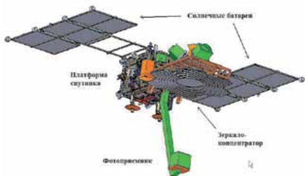
Рис. 1. Детектор космических лучей предельно высоких энергий ТУС на спутнике «Михаил Ломоносов». Площадь зеркала-концентратора 2 м 2 , число ячеек фотоприемника 256.
