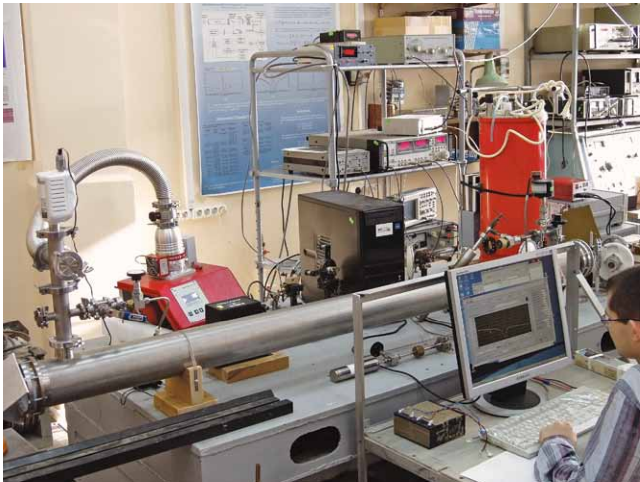
Рис. 2. Внешний вид субдоплеровского спектрометра мм и суб-мм диапазонов длин волн на основе провала Лэмба, созданного в ИПФ РАН при поддержке РФФИ.
