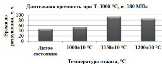
Рис. 6. Влияние температуры отжига интерметаллидного сплава ВКНА-1В на время до разрушения при испытаниях на длительную прочность при температуре 1000°С при постоянном напряжении 180 МПа.
