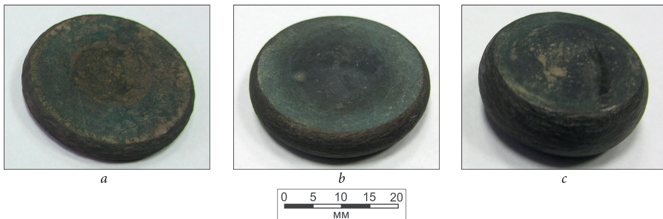
Рис. 7. Внешний вид образцов из опытного орто-сплава после изотермической осадки по следующим режимам: a – T=1180 °C, \epsilon=75\% ; b – T=900 °C, \epsilon=75\% ; c – T=900 °C, \epsilon=50\% .
