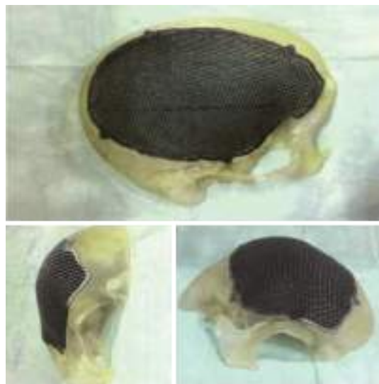
Титановые имплантаты сетчатой структуры, полученные при помощи трехмерной печати
