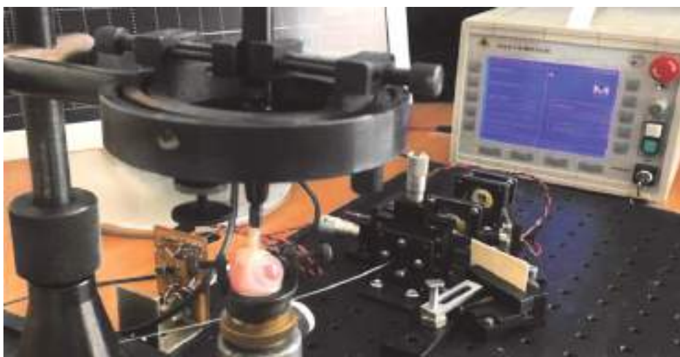
Экспериментальный образец установки с обратной связью для снижения внутриглазного давления с помощью лазерного излучения на длине волны 1,56 мкм. Эксперимент на склере выделенного глаза кролика
