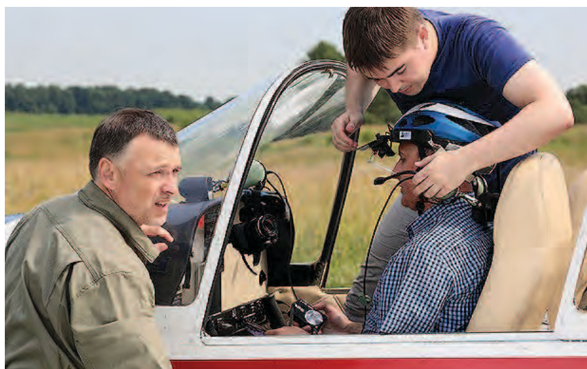
Рис. 6. Фиксация мобильной системы видеорегистрации движений глаз SMI iView X HED на голове пилота.
