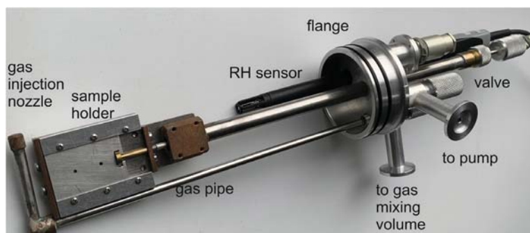
Рис. 3. Вставка для герметичной камеры ТГц-спектрометра для измерения образцов при контролируемой влажности. Зонд для измерения влажности и температуры газа устанавливается во фланец датчика влажности (RH sensor).
