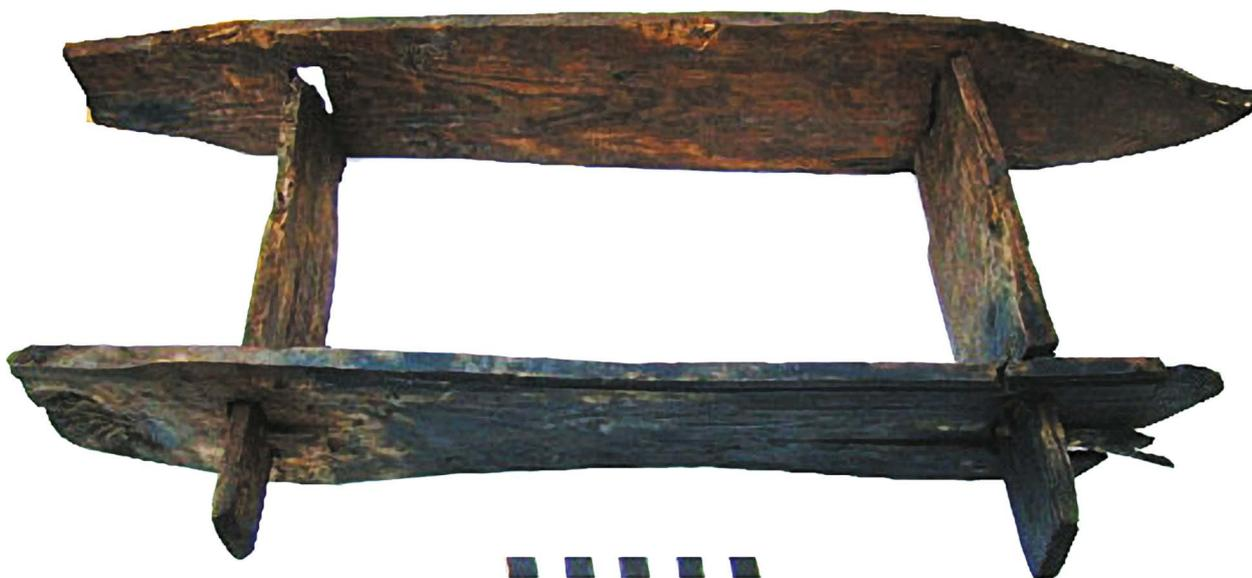
Рис. 14. Деревянная разъемная форма для изготовления кирпичей
