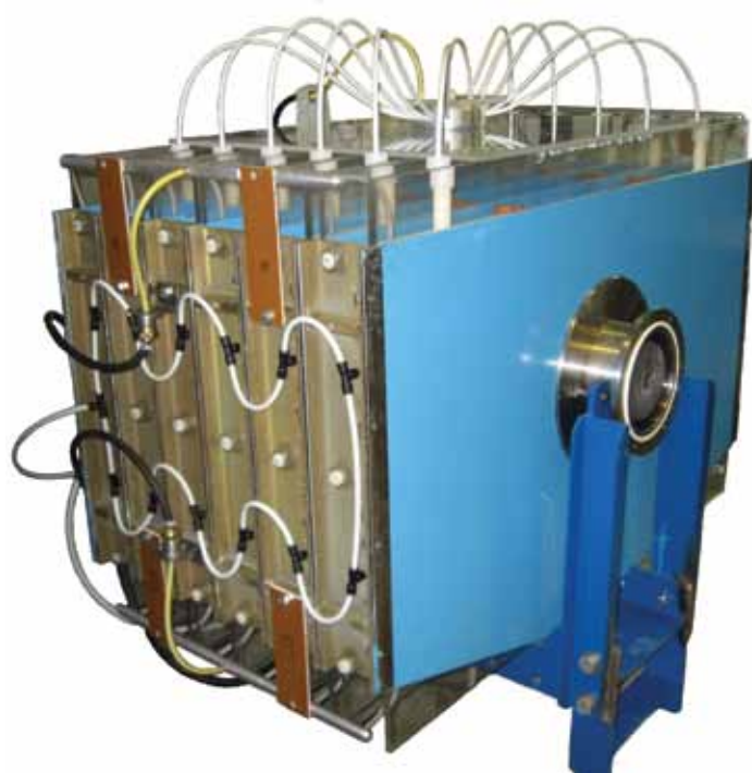
Рис. 3. Фотография линейного импульсного трансформатора без нагрузки.
