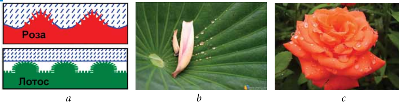
Рис. 5. Структуры «двойной шероховатости» на поверхности лепестка розы и листа лотоса (а). Капли воды на поверхности листа лотоса (b) и лепестка розы (с).
