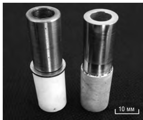
Рис. 1. Образцы до (слева) и после (справа) пайки: верхняя часть – титан ВТ-5, нижняя часть – керамика ВК94-1.
