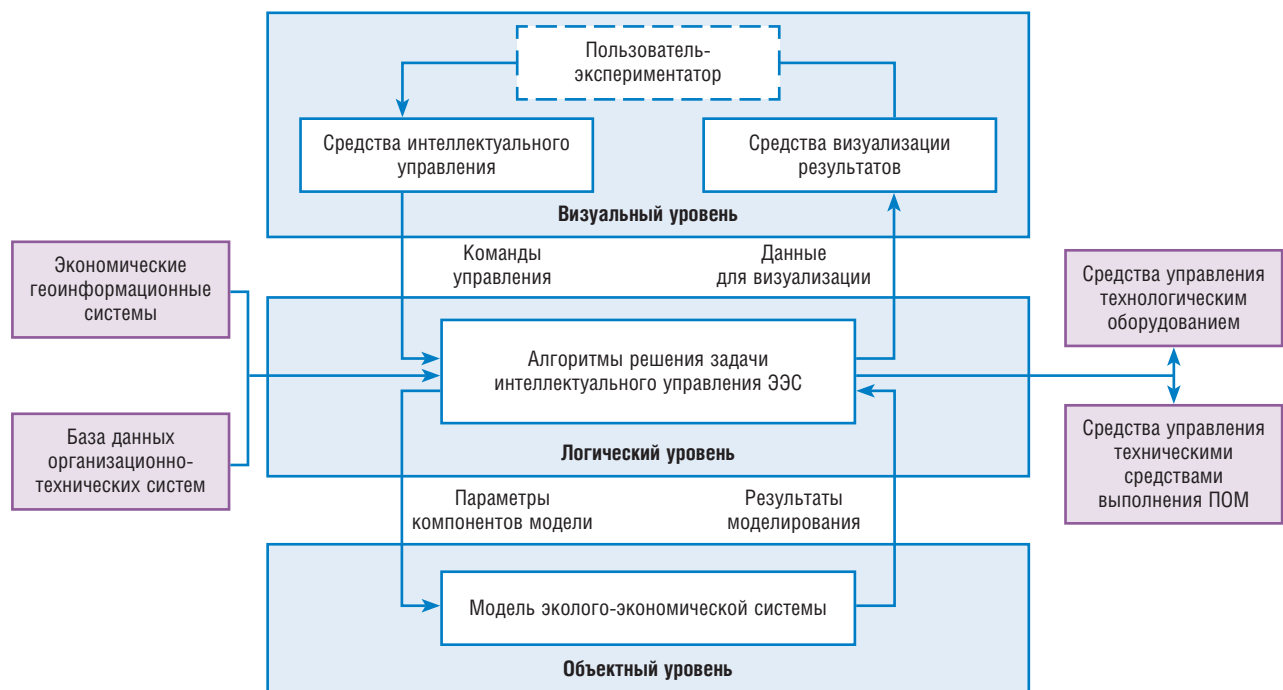
Рис. 1. Архитектура системы многоуровневого компьютерного моделирования.
