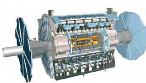
Рис. 7. Схематическое изображение детектора ATLAS. Разными цветами помечены отдельные части детектора, предназначенные для регистрации частиц разных типов, точного определения треков заряженных частиц и т.д. Стоит обратить внимание на фигурки людей внизу и слева, они показывают масштаб.
