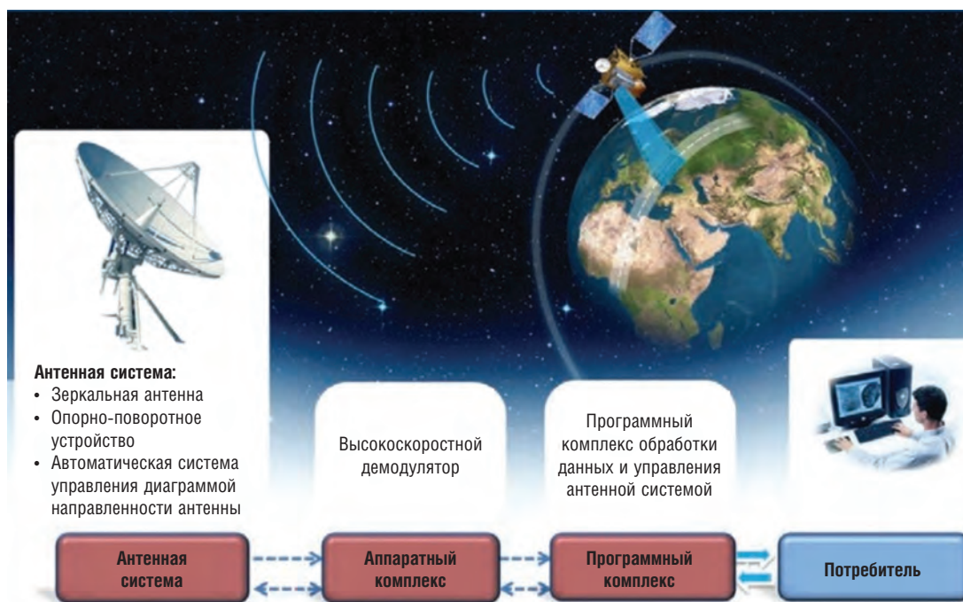
Рис. 2. Функциональная схема работы наземного комплекса приема и обработки данных.
