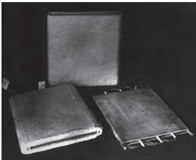
Рис. 2. Опытные образцы отформованной теплоизоляции с покрытием, предназначенные для испытаний при температурах 1500–2200 °С.
