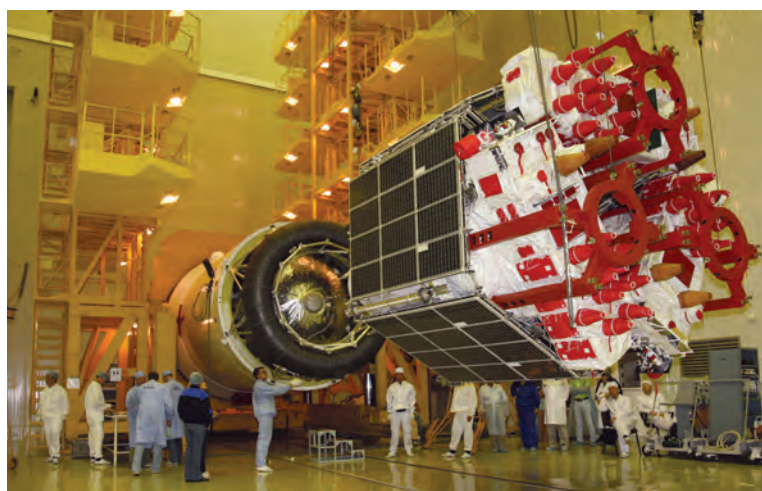
Рис. 10. КА «Глонасс-М»: стыковка блока из трех КА с разгонным блоком на космодроме.
