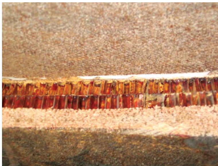
Рис. 1. Теплозащита космического корабля «Восток-1» в разрезе.
