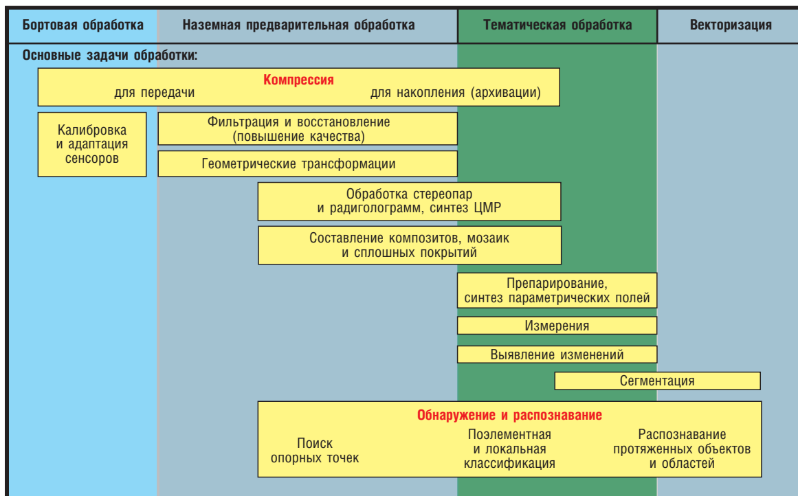
Рис. 4. Обработка аэрокосмических изображений для ГИС. ЦМР – цифровая модель рельефа.
