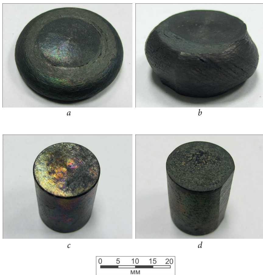
Рис. 8. Внешний вид осажденных образцов из опытного ортосплавa: а – T=850\text{ }^{\circ}\text{C} , \varepsilon=75\% ; б – T=850\text{ }^{\circ}\text{C} , \varepsilon=50\% ; в – T=800\text{ }^{\circ}\text{C} , \varepsilon=75\% ; д – T=800\text{ }^{\circ}\text{C} , \varepsilon=50\% .
