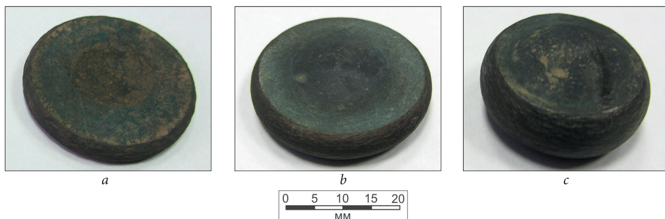
Рис. 7. Внешний вид образцов из опытного орто-сплава после изотермической осадки по следующим режимам: a – T=1180 °C, \varepsilon=75\% ; b – T=900 °C, \varepsilon=75\% ; c – T=900 °C, \varepsilon=50\% .
