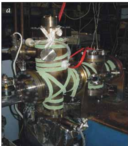
Рис. 8. Внешний вид (а) и схема (б) магнитооптической ловушки для атомов магния.
