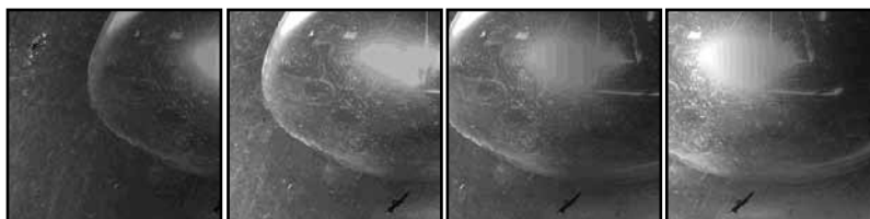
Рис. 8. Последовательность кадров, полученная на лабораторном макете гиперспектрометра для спирали лампы накаливания.
