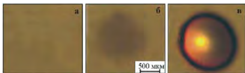
Рис. 4. Микрофотографии пленки ПЭМА с введенным прекурсором серебра (10 мг/1 мл), при различных длительностях лазерного облучения t: а) t=0; б) t=1 мин; в) t=10 мин I_{\text{лаз}}=20 \text{ Вт/см}^2
