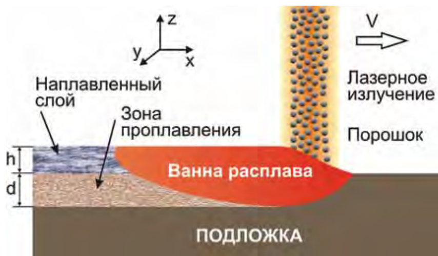
Рис. 1. ЛС с коаксиальной инжекцией порошков (схема)
