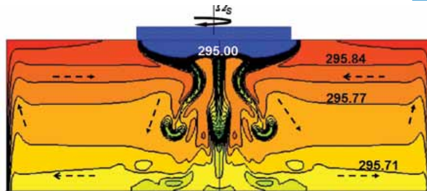
Рис. 6. Образование «холодных термиков» под фронтом кристаллизации ( T_M = 295.00 K) при кристаллизации гептадекана в режиме совместного действия тепловой конвекции и вращения закристаллизовавшейся области. Сплошные линии – изотермы со значениями температуры [K]. Направление основного течения расплава показано пунктирными стрелками.
