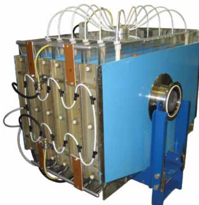
Рис. 3. Фотография линейного импульсного трансформатора без нагрузки.
