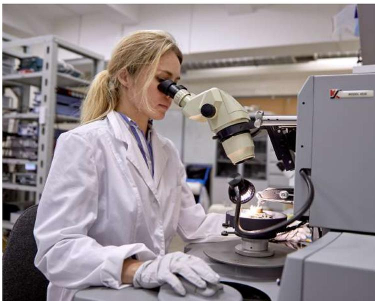
Научный сотрудник лаборатории топологических квантовых явлений в сверхпроводящих системах МФТИ Ольга Скрыбина контролирует процесс микросварки контактов к чипу. Фото: Евгений Пелевин / Пресс-служба МФТИ
