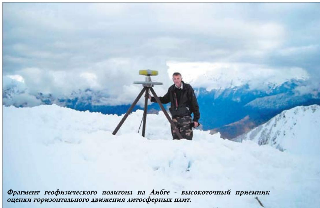
Фрагмент геофизического полигона на Аибге - высокоточный приемник оценки горизонтального движения литосферных плит.
