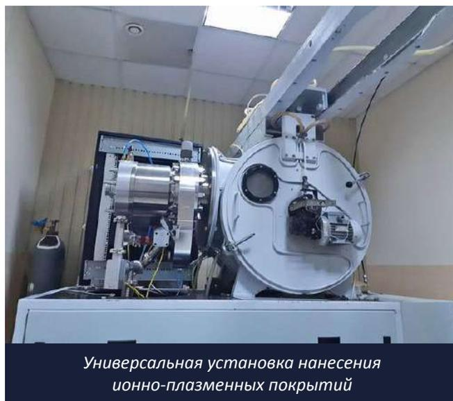
Универсальная установка нанесения ионно-плазменных покрытий
