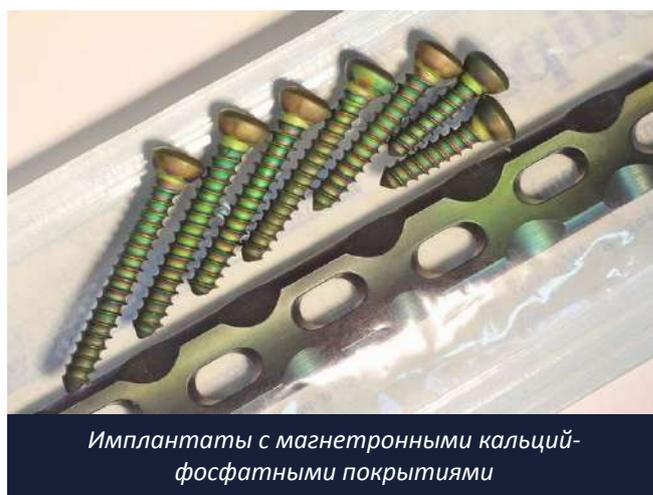
Имплантаты с магнетронными кальций-фосфатными покрытиями
