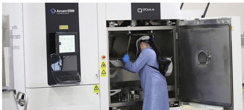
Пример EBM 3D-принтера – промышленная аддитивная установка Q20plus производство шведской компании Arcam AB (ныне в составе корпорации General Electric)
